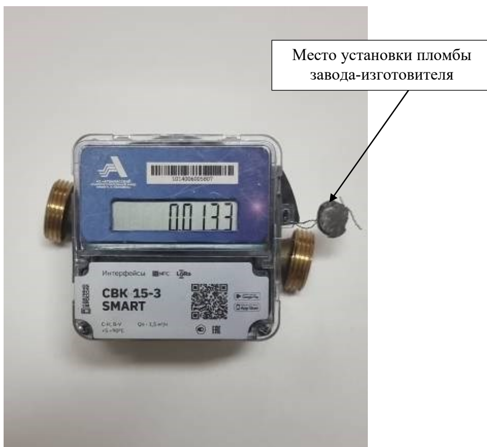
Рисунок 2 - Схема пломбировки от несанкционированного доступа
